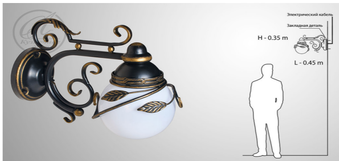
T/X по теме: Фонарь НБУЗ 31 (Галактика). Материал: Опора: Сталь - (С15ГС, 08ГС). Рассеиватель: Шар 250 (Полимер Опал). Грунт: - Эмаль 3в1 (антикоррозийный). Краска: Порошок RAL9005(Черный). Патина: WS - Patina (под Золото). Электрокомплектация: E 27. ПВС 2X1. ЗВИ - 3 ГС. Для индивидуального подхода по теме Т/Х контакт с производством тел. факс: (8652) 23 04 81. (8652) 22 04 41.
