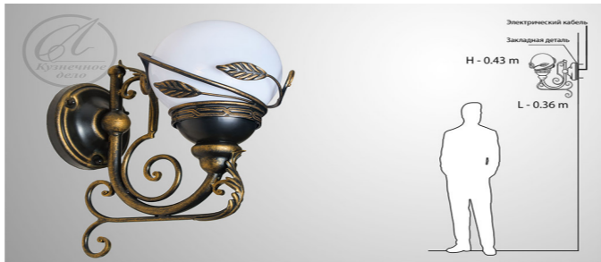
T/X по теме: Фонарь НБУЗ 31 (Галактика). Материал: Опора: Сталь - (С15ГС, 08ГС). Рассеиватель: Шар 250 (Полимер Опал). Грунт: - Эмаль 3в1 (антикоррозийный). Краска: Порошок RAL9005(Черный). Патина: WS - Patina (под Золото). Электрокомплектация: E 27. ПВС 2X1. ЗВИ - 3 ГС. Для индивидуального подхода по теме Т/Х контакт с производством тел. факс: (8652) 23 04 81. (8652) 22 04 41.
