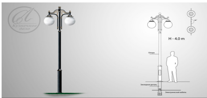
T/X по теме: Фонарь Павел 2. Н - 4,0 м. Материал: Опора: Сталь - (С15ГС, 08ГС). Рассеиватель: Шар 400 (Полим Сталь - (С15ГС, 08ГС)). Грунт: - Эмаль 3в1 (антикоррозийный). Краска: Forgent Paint (Черный). Патина: WS - Patina (под Золото). Электрокомплектация: E 27. ПВС 3X1,5. BA47 -29. ЗНИ-16. Для индивидуального подхода по теме Т/Х контакт с производством тел. факс: (8652) 23 04 81. (8652) 22 04 41.
